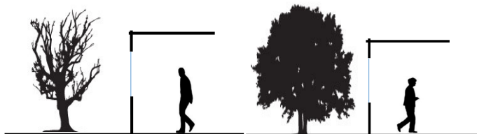
图 3.0.7-3 利用树木形成自然遮阳示意图
